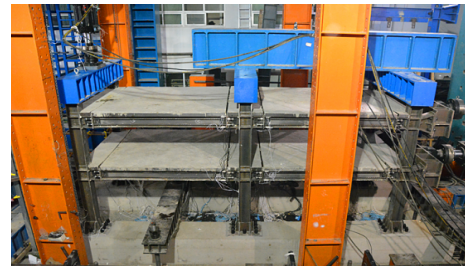
图9 装配式可恢复功能空间钢框架试验
