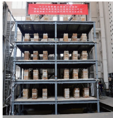
图4 设置芯筒的全螺栓连接钢框架振动台试验
