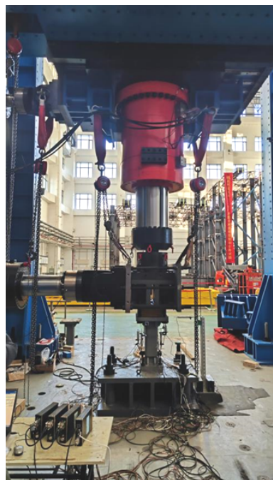
图13 模块化组合结构连接轴向拉弯性能试验 Fig. 13 Axial tension-bending performance test of modular composite structure connections
