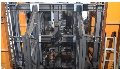
图7 设置中间柱型阻尼器的可恢复功能钢框架试验
